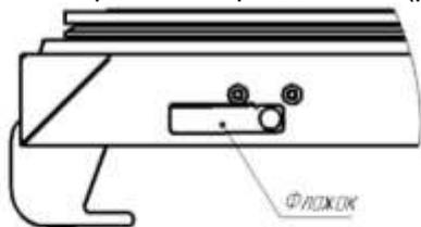
Рис. 2 Положение флажка для одновременного открывания/закрывания двух дверей
